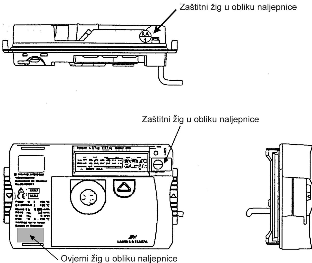
**Slika 2:** Zaštita računске jedinice mjerila toplinske energije od neovlaštena pristupa koju provodi isporučitelj toplinske energije
