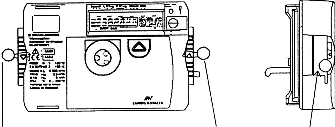
Zaštita od neovlaštena pristupa mjerilu koju provodi tvrtka koja isporučuje toplinsku energiju (sa svake strane po jedna olovna plomba ili zaštitna naljepnica)
